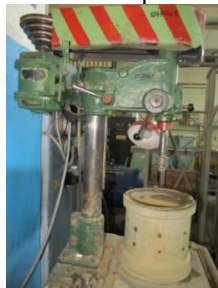
Рис. 2 – Пристрій для дослідження абразивного зносу
